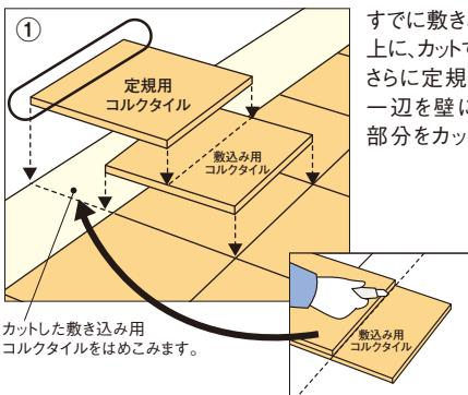
すでに敷きこんであるコルクタイルの上に、カットするコルクタイルを重ねます。さらに定規用のコルクタイルを重ね、一边を壁にぴったり合わせて露出部分をカッターナイフでカットします。
