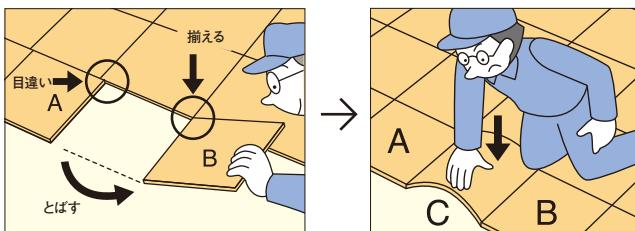
敷き込みの途中で万が一コルクタイルAに目違い(2~3mm程度)が生じた場合は1枚分飛ばしてBを正位置に貼り、AB間にCを曲げて押し込むように貼ってください。
