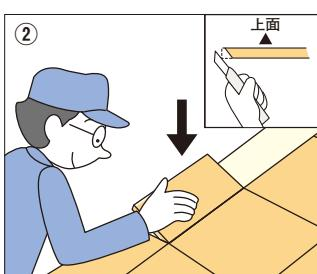
できあがったコルクタイルの壁に当たる面を斜めにカットし、壁際へ敷き込みます。仕上げにハンドローラーで押さえます。
