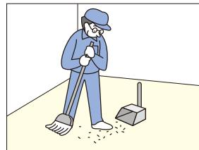
下地表面を平坦に整え、汚れや米粒大のゴミを完全に取り除き乾燥させます。
