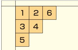
コルクタイルは先に引いた基準線が交差する所から貼り始めます。その際、片寄って力を加えると目地に狂いが生じますので均一に力を加え、すき間が生じないように注意してください。
